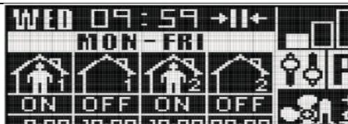
Пример запрограммированного календаря (рабочие дни). Устройство будет включено в 8:00 и будет выключено в 10:00. Устройство снова включится через 6 часов в 18:00 и проработает до 00:00. Данные настройки распространяются на рабочие дни с понедельника по пятницу.
